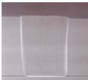
(d) Exposure = 6000 mJ/cm<sup>2</sup>, Focus= -20 μm
